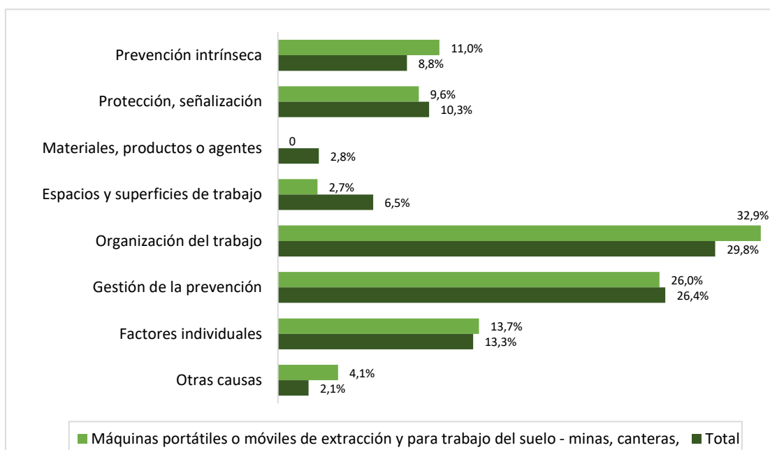
Gráfico 58. Bloques de causas de los ATM debido al agente Máquinas portátiles o móviles para trabajo del suelo –minas, canteras, obras de construcción
